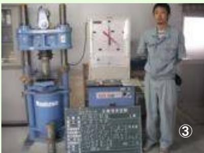
強度はコンクリートが崩壊するときまで力をかけていき、崩壊したときの強度を測定します④。
