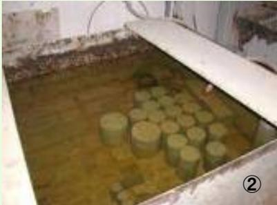
28日経ちましたら、その試験体を公的の試験機関に持ち込み試験機で圧力を掛けて壊れるまでの強度を調べます③。
