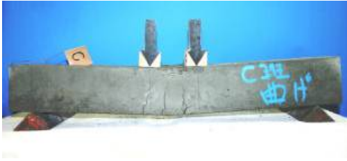
曲げ破壊の状況
